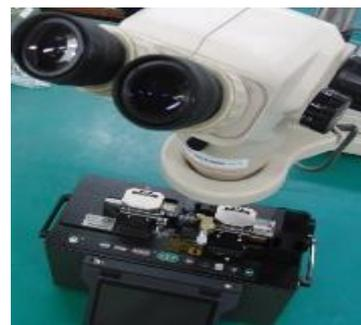
5. Enlever le miroir de vérification de hauteur de fibre. Attention de ne pas heurter la fibre.
