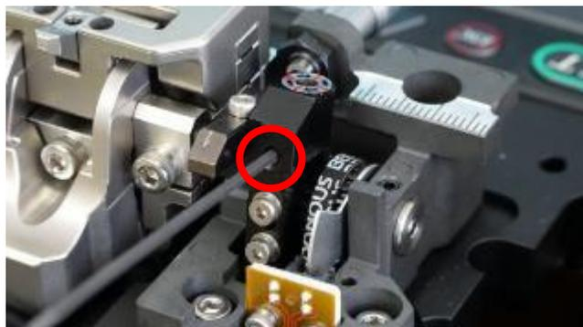
8. Tourner la vis de changement de position du couteau afin de changer sa position. 1/4 de tour de vis correspond à une nouvelle position du couteau. Aligner la marque rouge de la vis sur le marquage rouge suivant.
