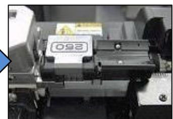
(3) position spécifique pour dia. > fibre 200µm avec FSM-100M/P
