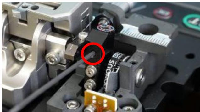
13. Tourner la vis d'ajustement de position du couteau dans le sens inverse des aiguilles d'une montre jusqu'à la position 1 comme sur la photo.
